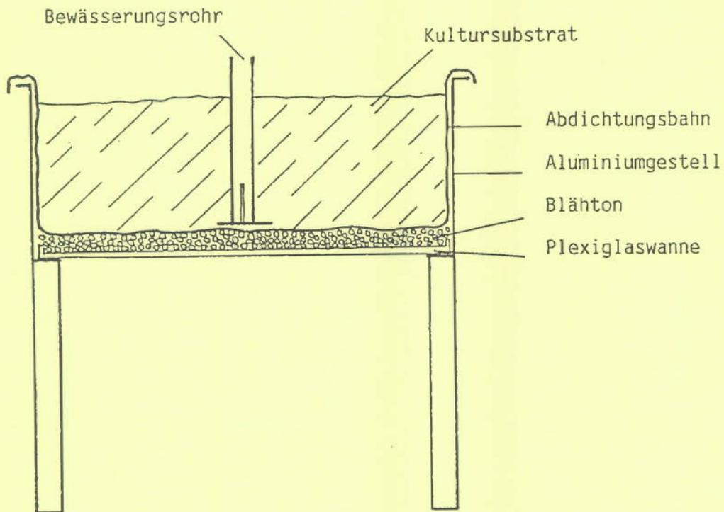
Abb. 1 Schnittbild durch das mit Testfolie und Kultursubstrat beschickte Prüfgefäß.
